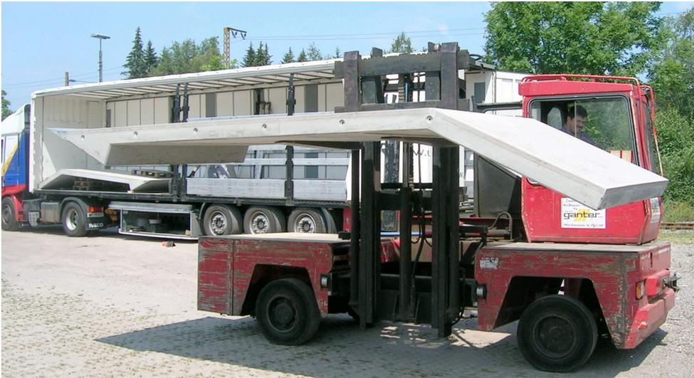
Zum Abladen der Elemente benötigen Sie einen Gabelstapler, einen Radlader oder einen Autokran mit Gabel (Gabellänge mind. 125 cm). Die Skateelemente mit einer Höhe bis zu 98 cm wiegen max. ca. 2500 kg und können mit einem Hubwagen versetzt werden.
